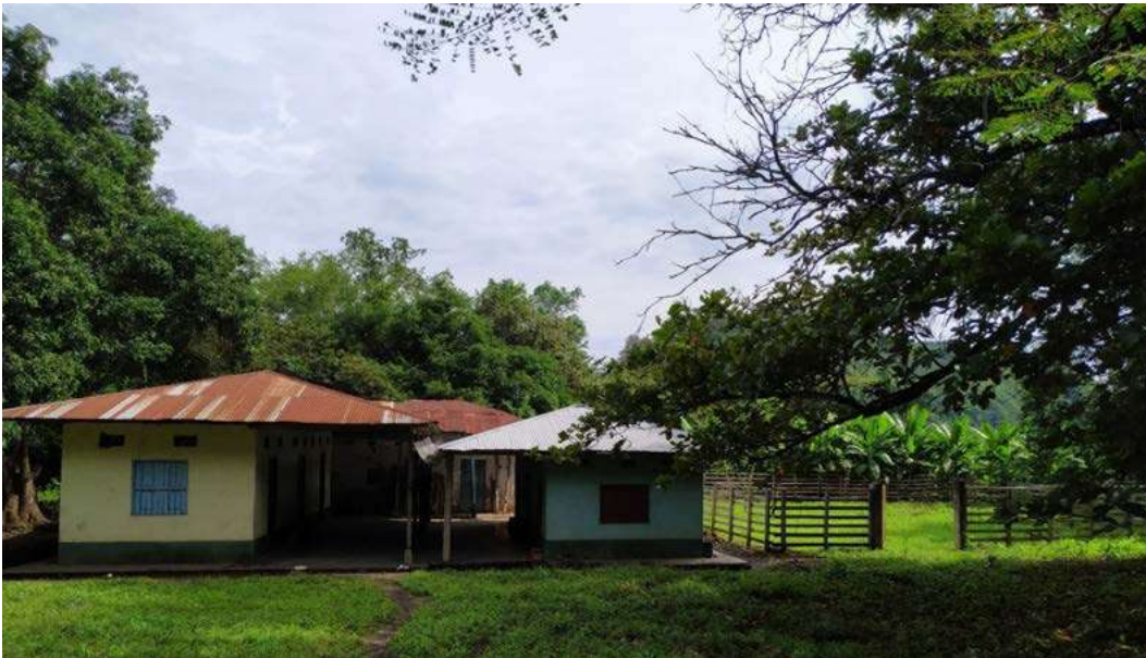
Imagen 26. Ejemplo de Vivienda Rural unifamiliar tradicional – bahareque con acabado en cal
