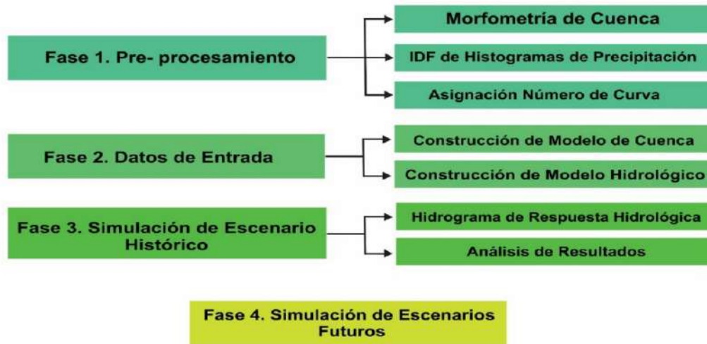
Gráfico 118. Metodología de análisis hidrológico cuencas no instrumentadas Municipio de Rovira.
